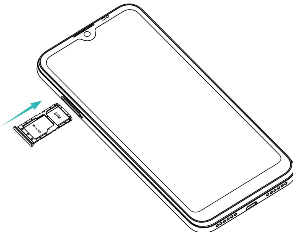
Cuando coloque la bandeja de la tarjeta, asegúrese de que esté nivelada y que la tarjeta esté correctamente alineada.
