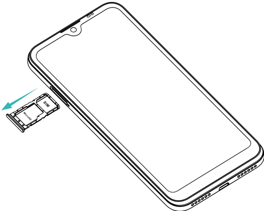
Para expulsar la tarjeta SIM o MicroSD, inserte la clavija de expulsión de la SIM en el pequeño orificio junto a la bandeja de la tarjeta.
